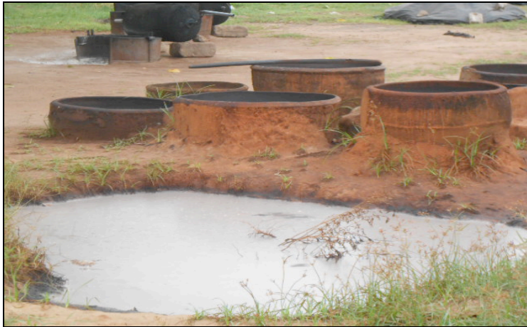
Photo 3 : Fosse à ciel ouvert accueillant les eaux usées
